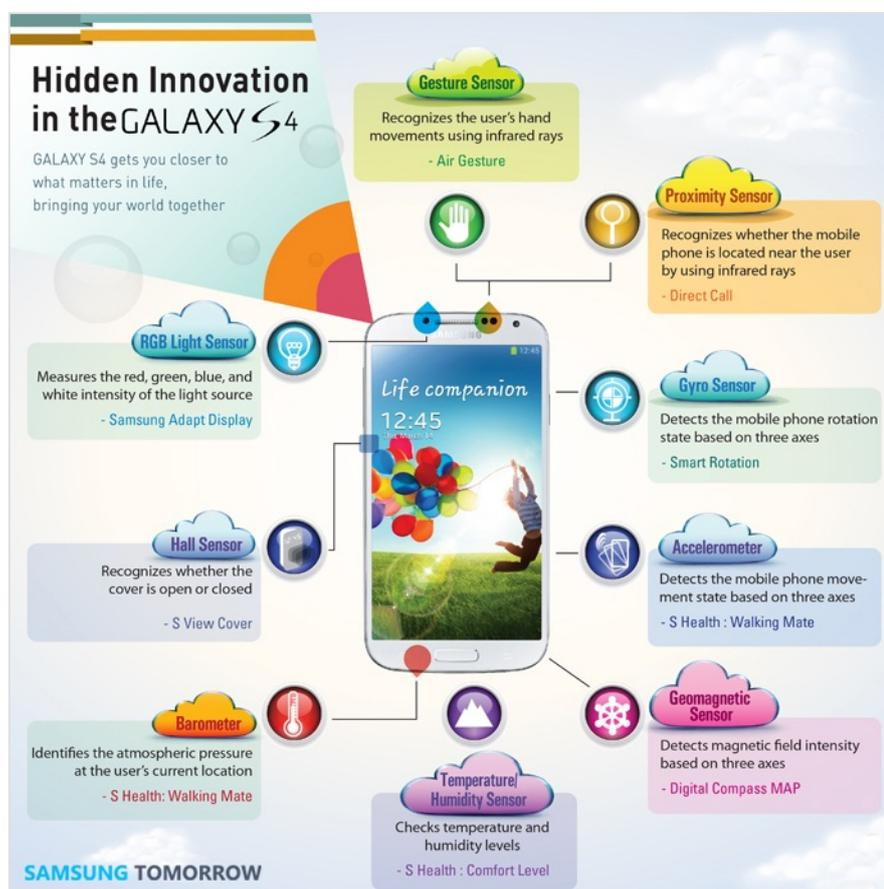
*Liste des capteurs innovants embarqués dans les téléphones Samsung Galaxy S4 et S5. On trouve en particulier un gyroscope, un capteur de gestes, une cellule photoélectrique capable de reconnaître la couleur de la lumière ambiante, etc.*
